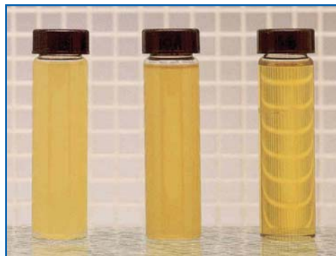
Élimination de l'eau libre dans une huile pour turbine typique : l'aspect limpide et brillant de l'huile montre l'absence d'eau libre
